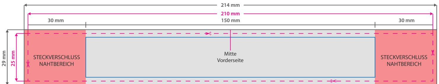
Der rote Bereich wird am Steckverschluss befestigt und zur Hälfte umgenäht, bitte hier nur Hintergrundgrafiken (Farbe, Foto etc) platzieren.
